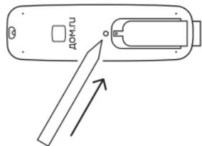
1. Для замены батареек в пульте дистанционного управления необходимо при помощи любого подходящего предмета надавить на защелку и немного сдвинуть крышку, как показано на рисунке.
